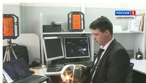
Новосибирские инженеры разработали умный шлем для спасателей. Кроме очевидной функции защиты головы, здесь есть также встроенный тепловизор и камера. Изображение с тепловизора показывается на очках. Тепловизор позволяет спасателю видеть сквозь дым. Но главная функция — дополненная реальность, которая также отображается в очках на каске. Сообщения из диспетчерской. План здания или шахты. Связь с пунктом управления — через Интернет.
