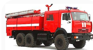
Автоцистерна пожарная объемом 8 куб.м. на шасси КАМАЗ 43118
