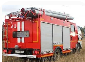
Новая пожарная автоцистерна АЦ 1,5-40/2 на шасси ISUZU
